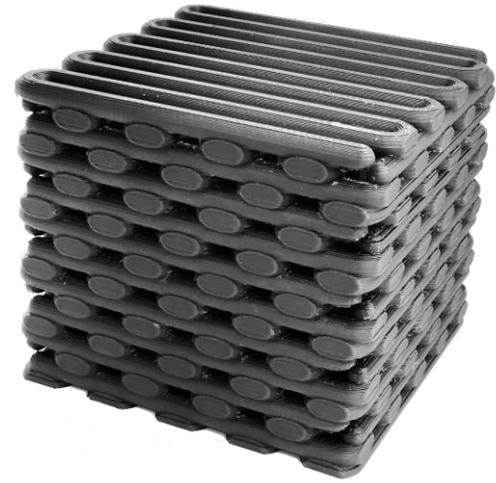
Dispositivos de captura y almacenamiento de CO<sub>2</sub> mediante dispositivos de bajo coste empleando nuevos con materiales nanoestructurados para capturar el CO<sub>2</sub>
